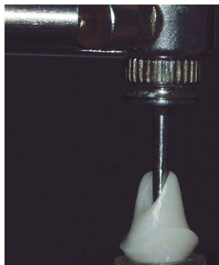
Fig. 3. Pilar individualizado en Circona Ytria y su control de torque a 30 N/cm 2 .
