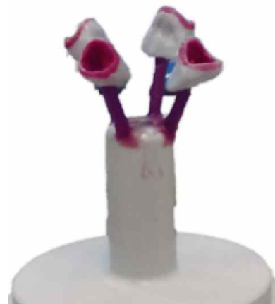
Fig. 4. Encerado de coronas previo al proceso de inyección.
